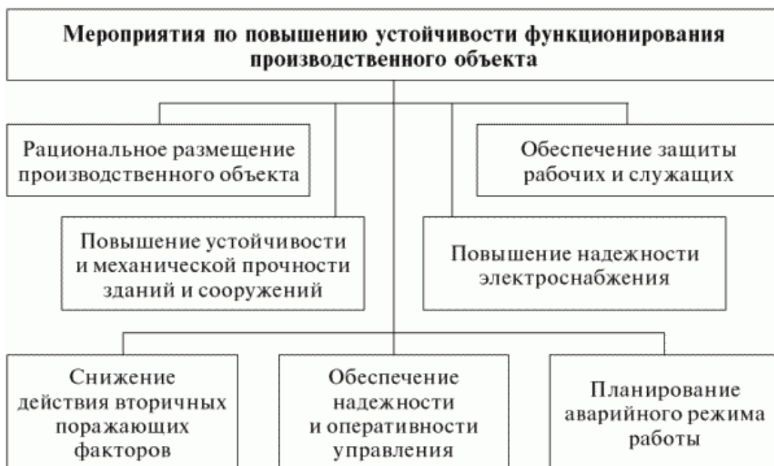
Рис. 5. Схема мероприятий по повышению устойчивости функционирования объекта
